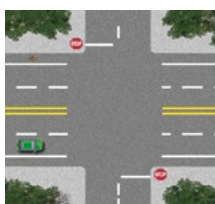
Cruces peatonales no marcados
