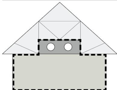
INVERTED SOFFIT OR MODIFIED TRUSS
