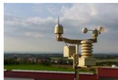
Un anemómetro (mini estación meteorológica) en funcionamiento.
