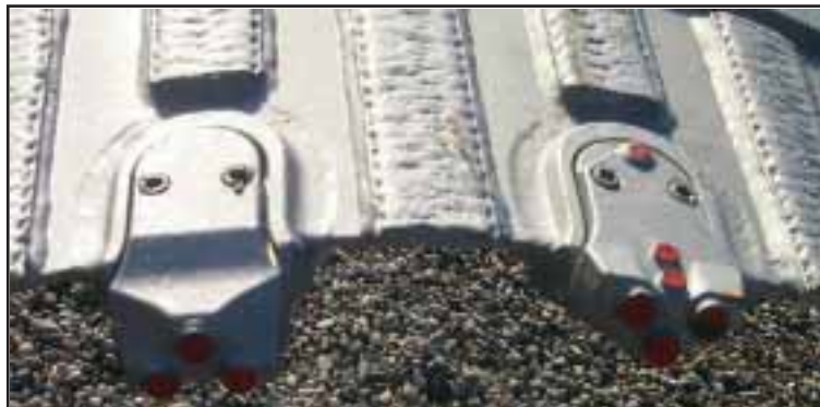
Zahnanordnung außen / innen vertikale Verschleißplatten Outer / inner cutting arrangement of teeth vertical hard faced wear plates
