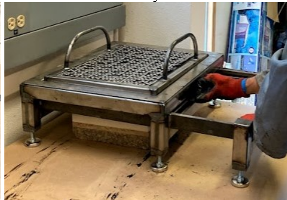
(d) Removing spreader sheet
