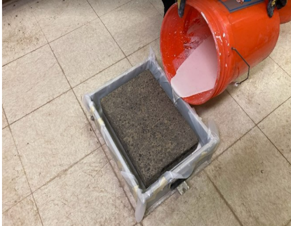
(d) Pouring plaster between mold and asphalt block
